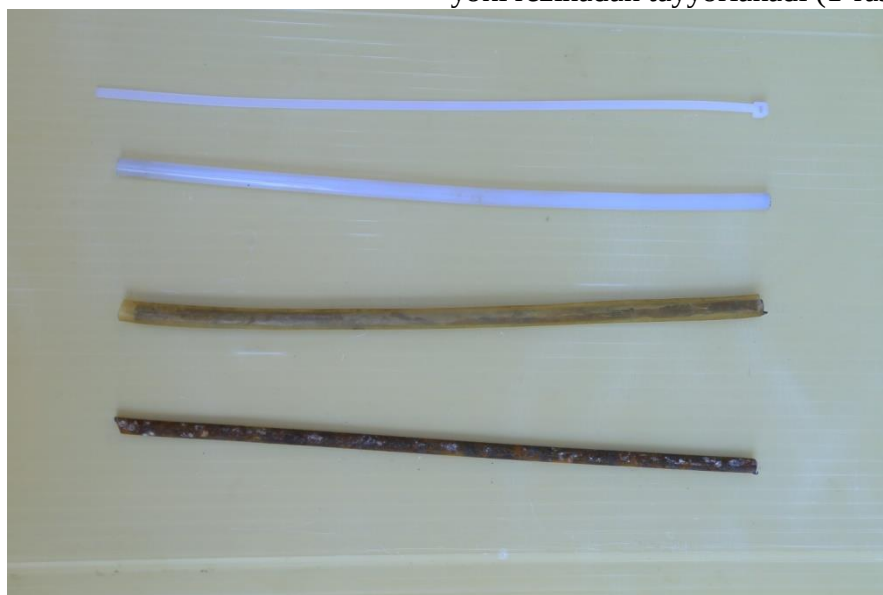
1-rasm. Sterjenlar variantlari: pastdan yuqoriga; 1-diametri 6 mm bo'lgan po'lat sterjen, 2-diametri 8 mm bo'lgan polietilen trubka, 3- diametri 6 mm bo'lgan to'liq polietilen sterjen, 4-eni 6 mm, qalinligi 2 mm bo'lgan polietilen bruscha.
